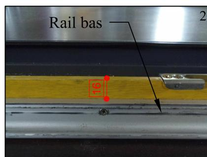
Dessus du rail bas doit être à 16 mm du fond de feuillure du dormant.
